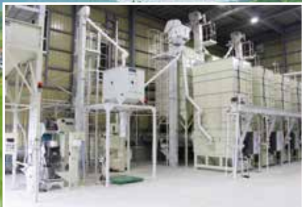
最大 40 トンの玄米が貯蔵できる乾燥機
